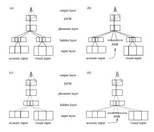
Figure 9. Lower level combination: (a) hidden layer (b) hidden layer and SNR (c) input layer (d) input layer and SNR.
