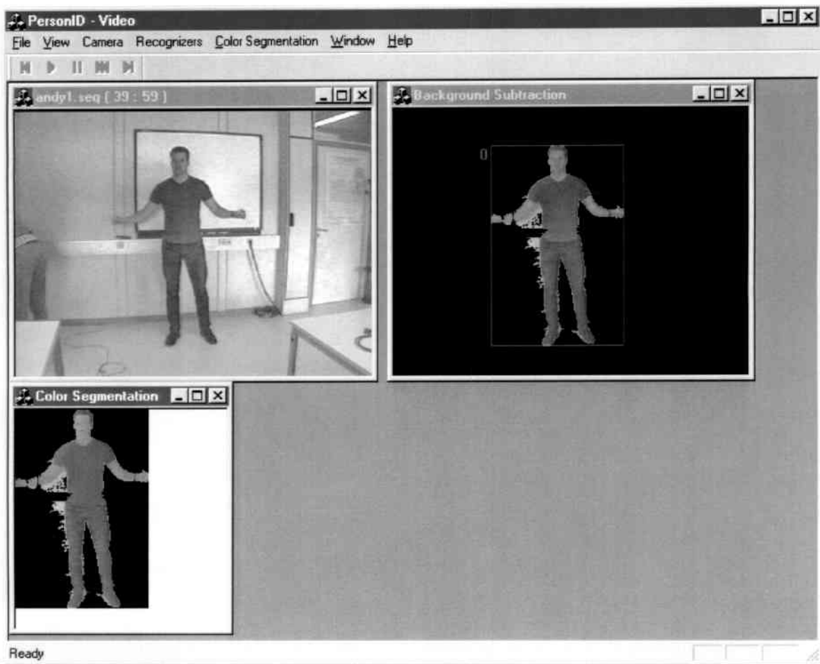
Abbildung 5.4: (links oben) Ausgangsvideobild, (rechts oben) Vordergrund-Hintergrund-Segmentierung, (unten) farbbasierte Segmentierung von Körperregionen
