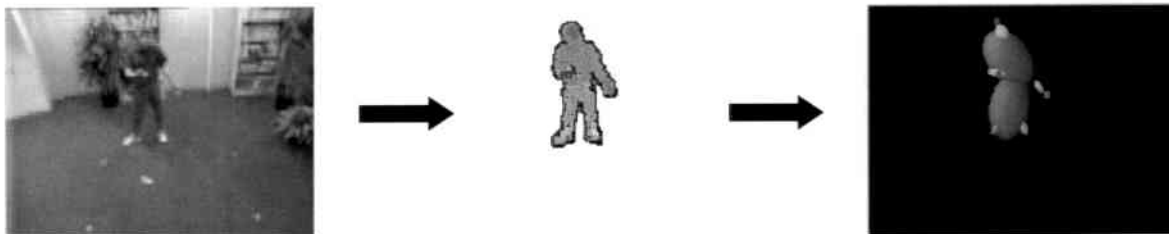
Abbildung 3.1: (links) Ausgangsvideobild, (Mitte) Segmentierung, (rechts) eine 2-D Repräsentation der Blobstatistiken
