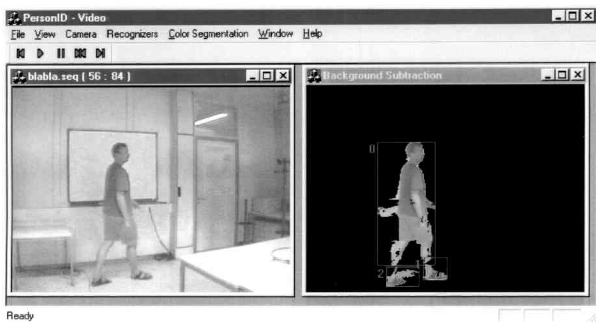
Abbildung 5.1: Personenverfolgung mittels Vordergrund-Hintergrund-Segmentierung
