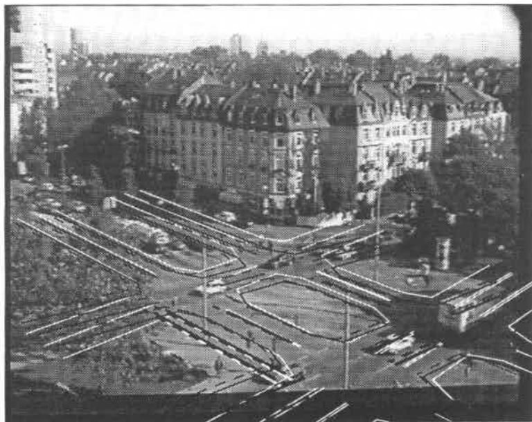
Abbildung 5.12: Ergebnis nach Prädiktion und Aktualisierung der Fahrbahnlage-schätzung nach Auswertung von 89 Halbbildern, wobei eine relative Geschwindigkeit zwischen der Lage von Kamera und Fahrbahnmodell in der Szene von 0 m/s angenommen wurde. Die initiale projizierte Modellage ist mit weißen Linien, die nach der Anpassung aktualisierte Lage mit dunklen durchgezogenen Linien dargestellt. Weiterhin wurde mit dunklen gestrichelten Linien die Projektion der Modellage visualisiert, die sich aus der Auswertung von nur einem Bild ergab (vgl. Abb. 5.11b), ohne die mit einem Kalmanfilter akkumulierten Schätzungen vorangehender Aufnahmen zu nutzen. Die Fehler, die auf die Fehlzuordnungen von Modellsegmenten an Datensegmente bewegter Fahrzeugabbilder zurückzuführen waren, haben deutlich abgenommen.
