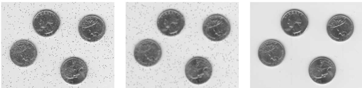
Abbildung 4.5: (links) Ausgangsbild mit zusätzlichem „Salt&Pepper“-Rauschen, (Mitte) Ergebnis des linearen Glättungsfilters, (rechts) Ergebnis des Medianfilters
