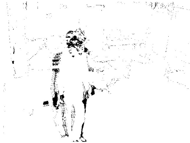
Abbildung 2.5. Resultierendes Binärbild der Vordergrund-Hintergrund-Segmentierung nach [18]. Hier schwarz eingefärbte Pixel wurden dabei dem Vordergrund zugewiesen, weiße Pixel dagegen dem Hintergrund. Durch die langsame Bewegung der beobachteten Person ziehen einige Pixel nach und wurden noch nicht korrekt als Hintergrund klassifiziert: ein schattenhaftes Nachziehen der Silhouette entsteht.
