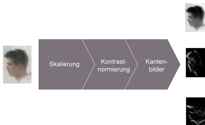
Abbildung 2.8. Die Vorverarbeitung der Kopfbilder besteht aus einer Skalierung der extrahierten Bilder, welche anschließend in ein Helligkeitsbild transformiert und im Kontrast normiert werden. Ferner werden jeweils ein vertikales als auch horizontales Kantenbild aus dem normierten Helligkeitsbild generiert.
