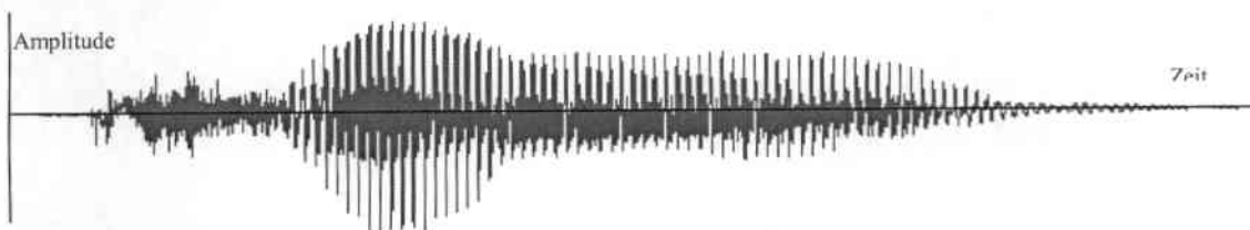
Abbildung 2.6: Analoges Signal der Äußerung "ta"
